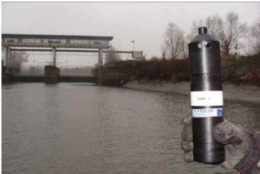
Figuur 11: Een akoestische VR2W-receiver (VEMCO, Halifax, Canada).
