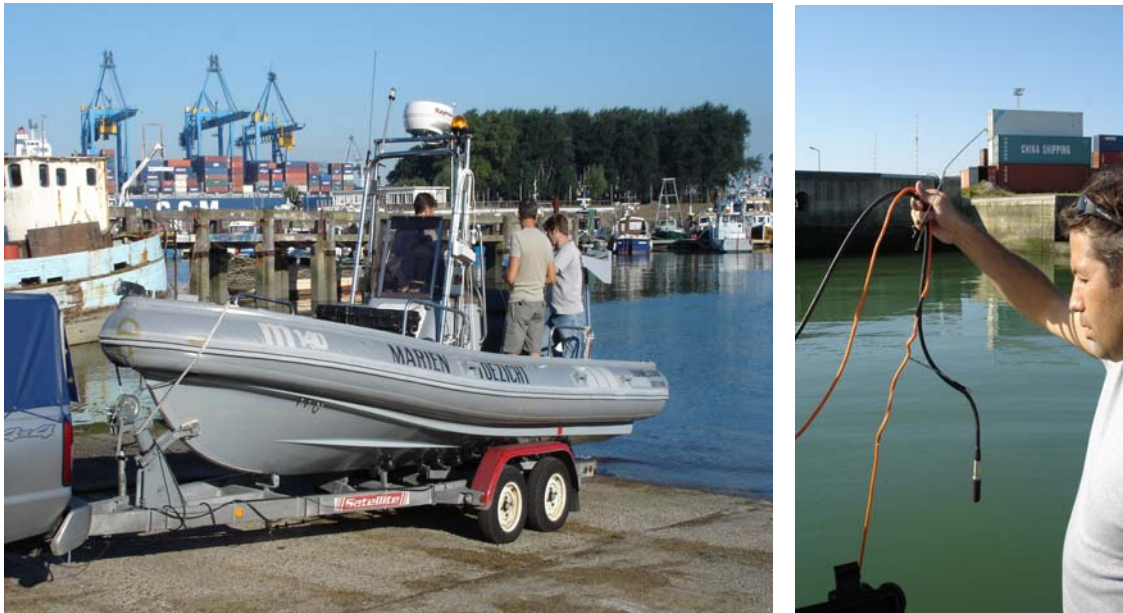
Fig. 1. Links: Meetapparatuur wordt op de Tuimelaar geïnstalleerd Rechts: Meethydrofoon wordt op afstand gehouden door ‘afhouders’
