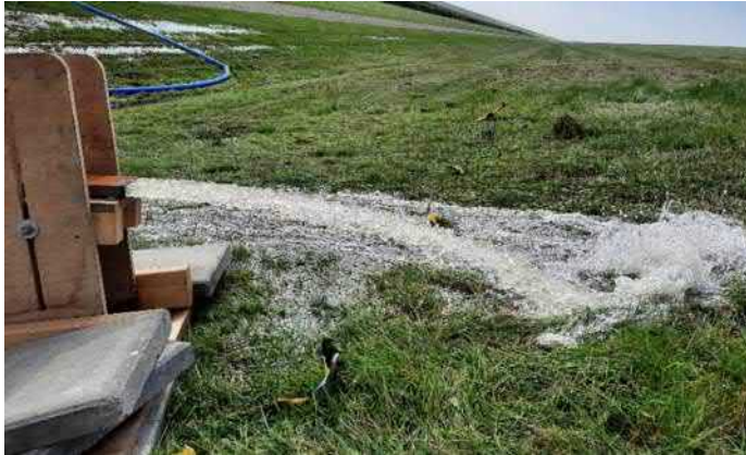
Figuur 2.14 Aangebrachte belasting bij stroomsnelheid van 4,5 m/s en een hoek van spuitmond van \alpha_s = 5^\circ .
