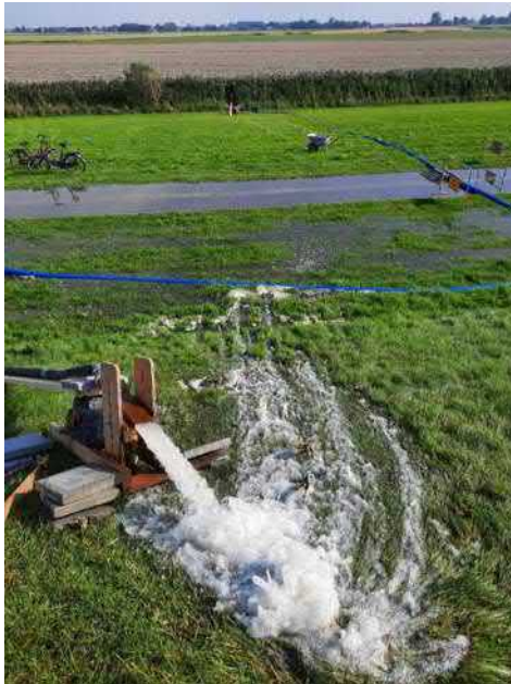
Figuur 2.11 Impressie van de spuitmond, hoek van spuitmond 20^\circ en stroomsnelheid 7,5 ms..
