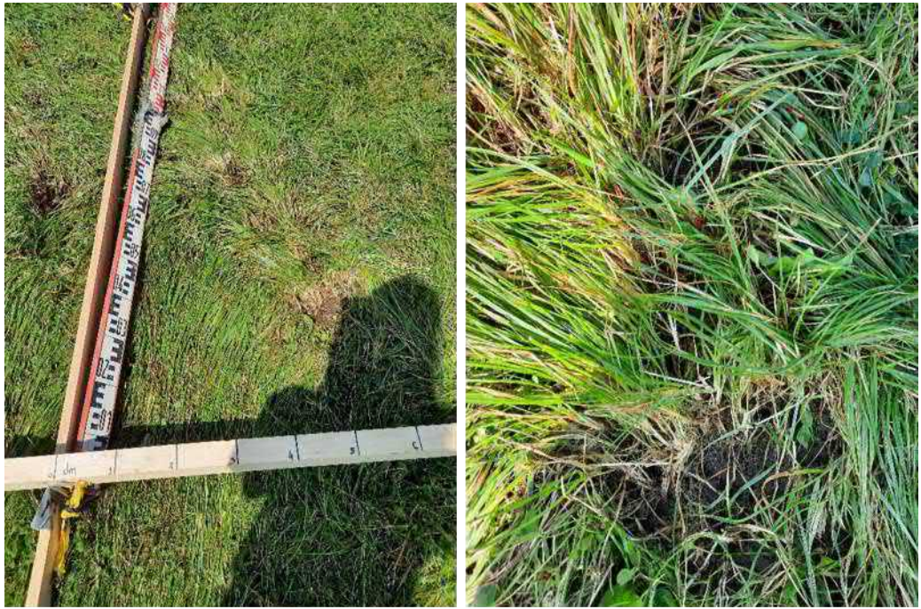
Figuur 0.32 Schade bij meting 1 van proef 1e.
