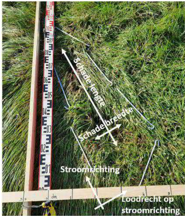
Figuur 3.2 Meting van maximale schade lengte en breedte.
