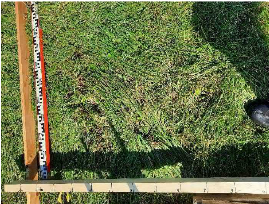
Figuur 0.10 Schade bij meting 1 van proef 1b.
