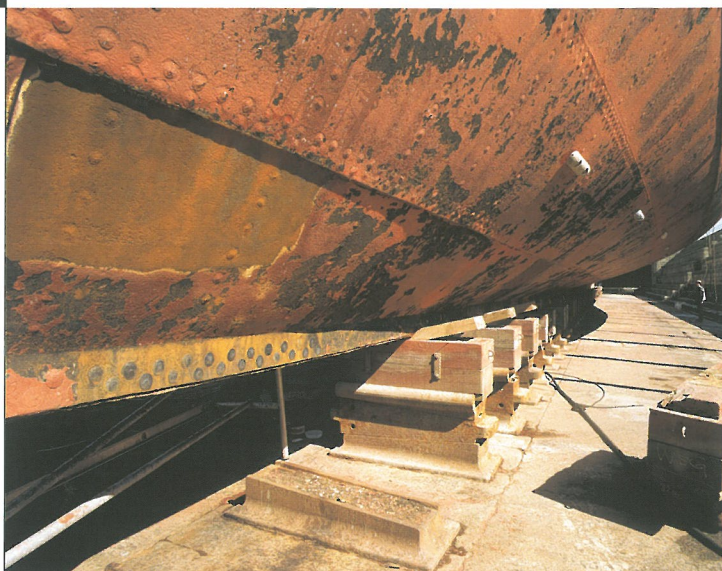
▲ Onder de waterlijn is een stalen plaat vervangen en vastgeklonken met klinknagels (foto O. Pauwels)
