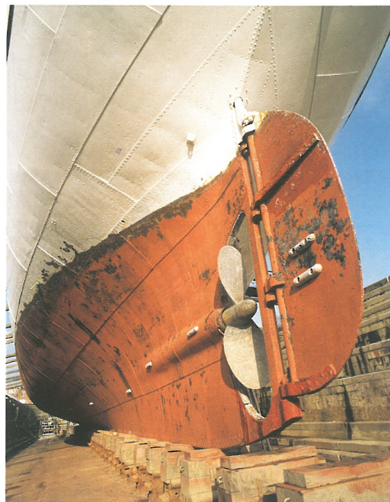
▲ Wanneer het schip onder zeil vaart wordt de schroef, die bij zeilschepen slechts uit twee pallen bestaat in loodrechte stand geplaatst zodat de vaart minder afgeremd wordt (foto O. Pauwels)
