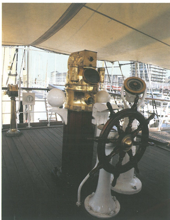
▲ Op het achterdek staat een magnetisch kompas en een stuurwiel dat kan gebruikt worden bij defect van het normaal stuurmechanisme op de brug (foto O. Pauwels)
