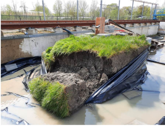
Figuur 9. Test 1 na 35 minuten testen, geotechnisch falen, afbreken van de rand van het blok.
