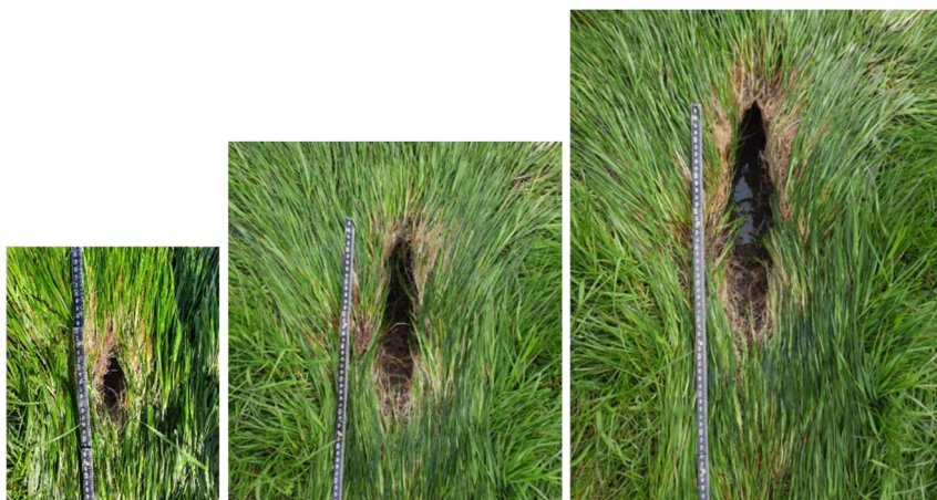
Figuur 14. Impressie schade Test 2 na 1h45min (21/4-1636 h), na 2h30min (22/4-0958h) en na 3h45min (22/4-1041h). De foto's zijn op ongeveer dezelfde schaal weergegeven. De stromingsrichting is aangegeven met de pijl.
