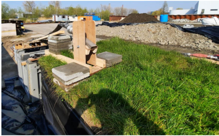
Figuur 6. Impressie van frame met spuitmond. Door de moeren aan weerszijden los te draaien kan de hoogte en de hoek van de spuitmond worden ingesteld.
