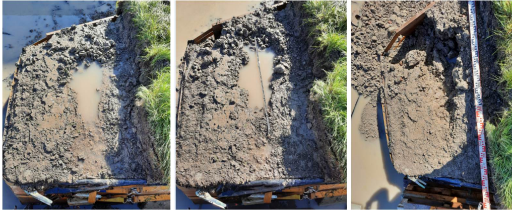
Figuur 18. Schade na circa 1 minuut, 2 minuten en 3 minuten
