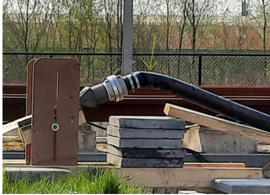
Figuur 20. Lichte knik bij aansluiting slang op spuitstuk. Mogelijk leidt dit tot extra weerstand.
