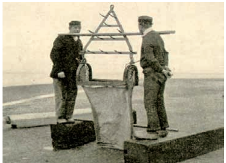
■ Het materiaal van Gilson voor het verzamelen van monsters: links een eenvoudig grijpstoestel voor het nemen van stalen op zandige bodems en rechts een klein sleepnet speciaal ontworpen voor de staalname op ruwe bodems (KBIN)
