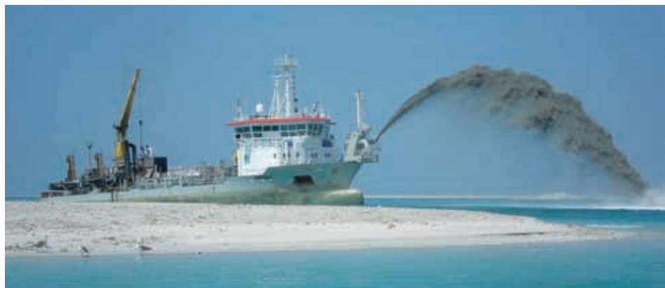
De rainbowtechniek: een baggerschip sproeit het zand-watmengsel rechtstreeks op de plaats van bestemming (TC)
