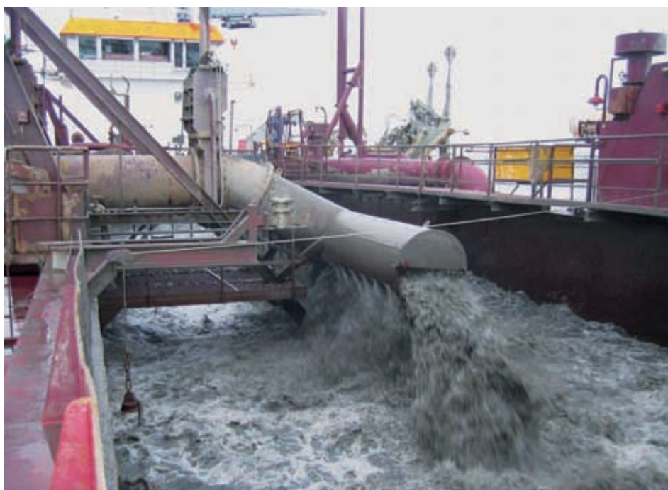
■ Het opgezogen mengsel van water en zand komt terecht in het beun van het baggerschip (BV)
