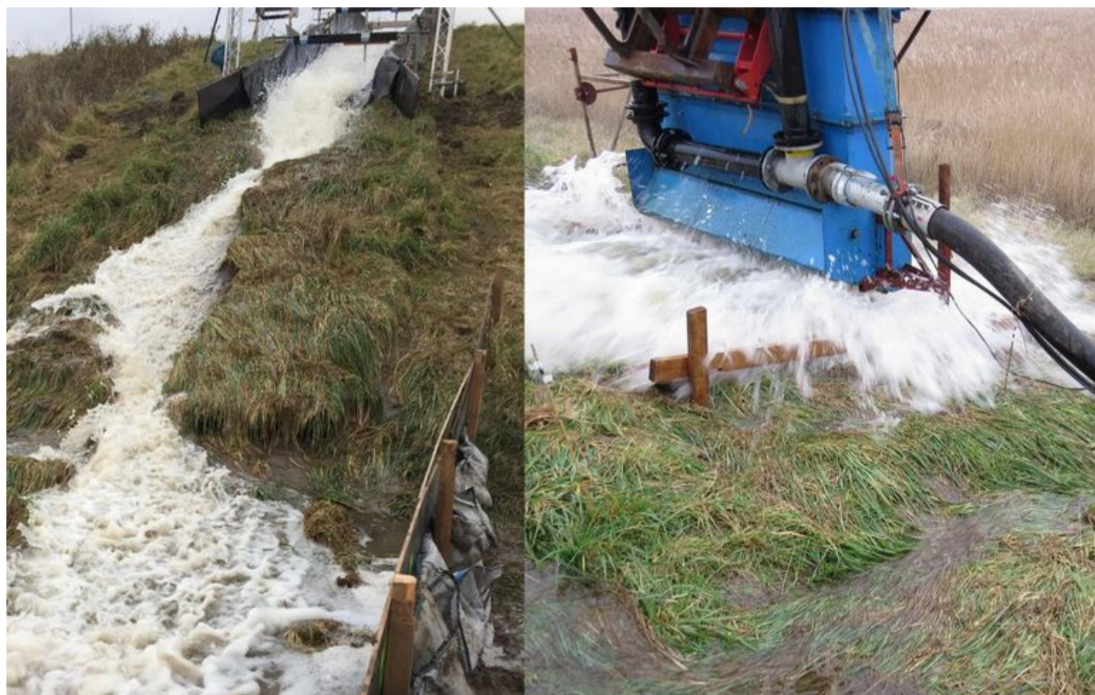
Twee manieren om de sterkte van zoden te testen onder extreme omstandigheden. Links de overlooptest van het Vlaamse Waterbouwkundig Laboratorium (binnenzijde dijk). Rechts de golfklaptest van INFRAM Hydren (buitenzijde dijk) (Bron: Kim van den Hoven)
