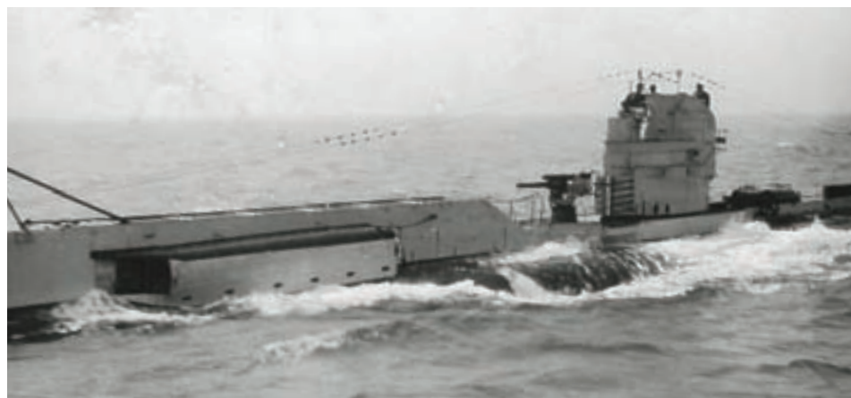
■ Een UC-II type duikboot op volle zee. Dit type duikboot was voorzien van 18 mijnschachten en een kanon voor de toren (Tomas Termote)
