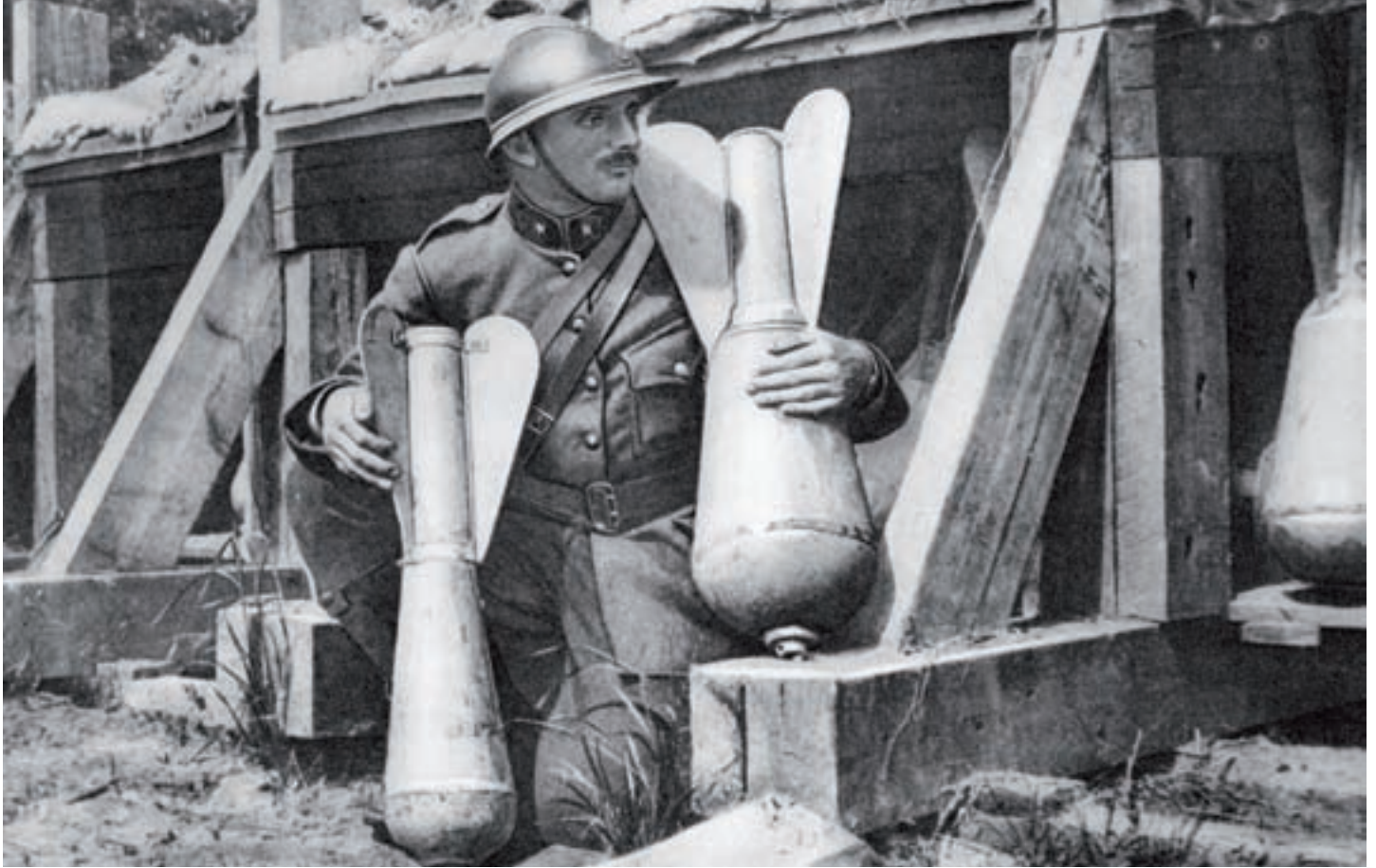
■ Door de grote stabilisatievinnen, kunnen deze mortiergranaten tijdens hun baan door de lucht op koers blijven (Luc Vandeweyer)
