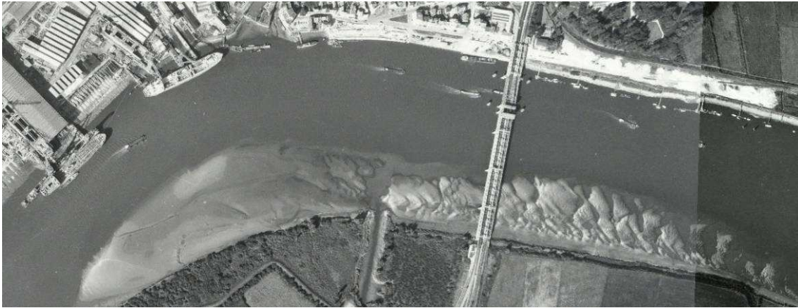
Figuur 5.2 – Labiele hoogdynamische slikfase met tijdelijk sterk ontwikkelde megarijvelen ter hoogte van de plaat van de Onbekende in 1969 (Temse)
