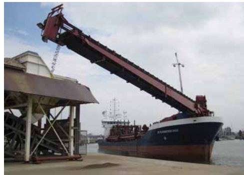
Figuur 6: Schets van een sleephopperzuiger (links) en een sleephopperzuiger bezig met het lossen van zeezand (rechts)
