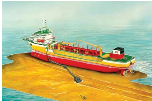
Figuur 6: Schets van een sleephopperzuiger (links) en een sleephopperzuiger bezig met het lossen van zeezand (rechts)
