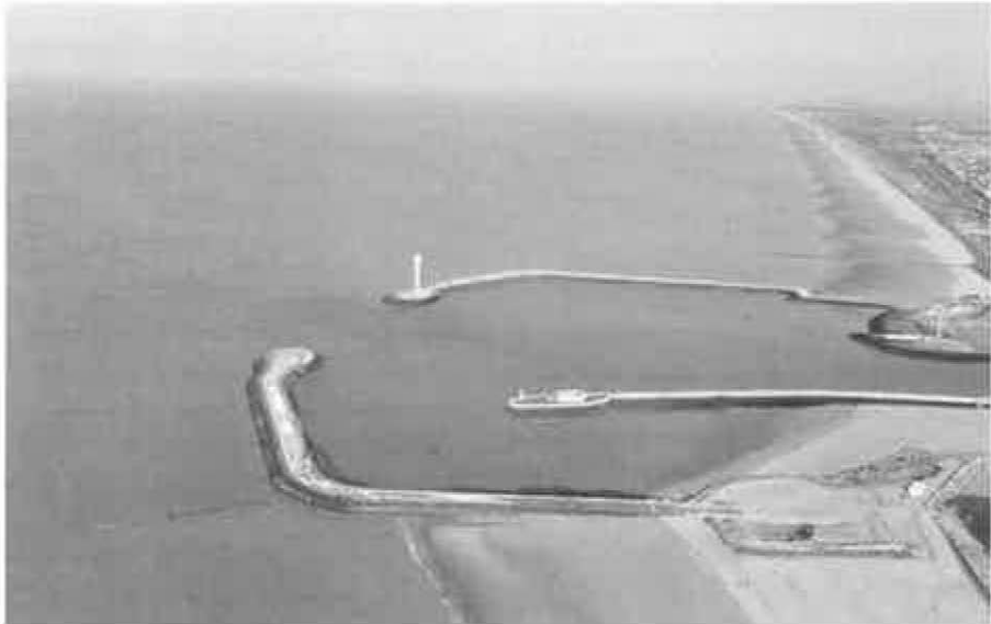
Foto 1: Luchtfoto van de monding van de Oostendse haven met, van onder naar boven, op de voorgrond de nieuwe westelijke havendam, het eigenlijke Klein Strand, het centrale oude westelijke staketsel, de havengeul en bovenaan de nieuwe oostelijke havendam. (KBIN)
