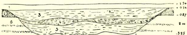
Pl. III. Coupe géologique montrant les dépôts fluviatiles dans le polder de Steenborgerweert à Anvers. (L'échelle des hauteurs est 20 fois plus grande que celle des longueurs.)
