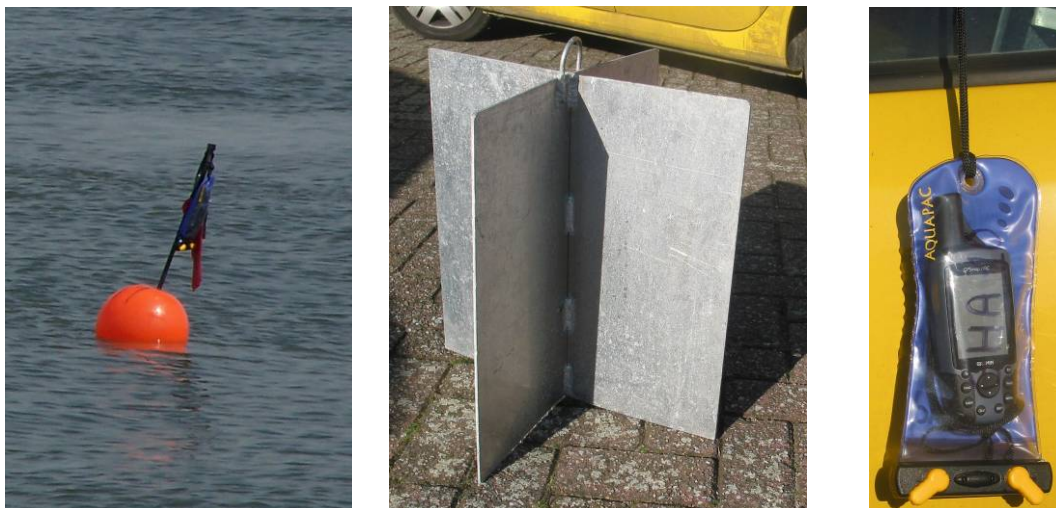
Figuur 2 – Onderdelen GPS vlotter: boei (links), kruisvormig paneel (midden), GPS-toestel (rechts)
