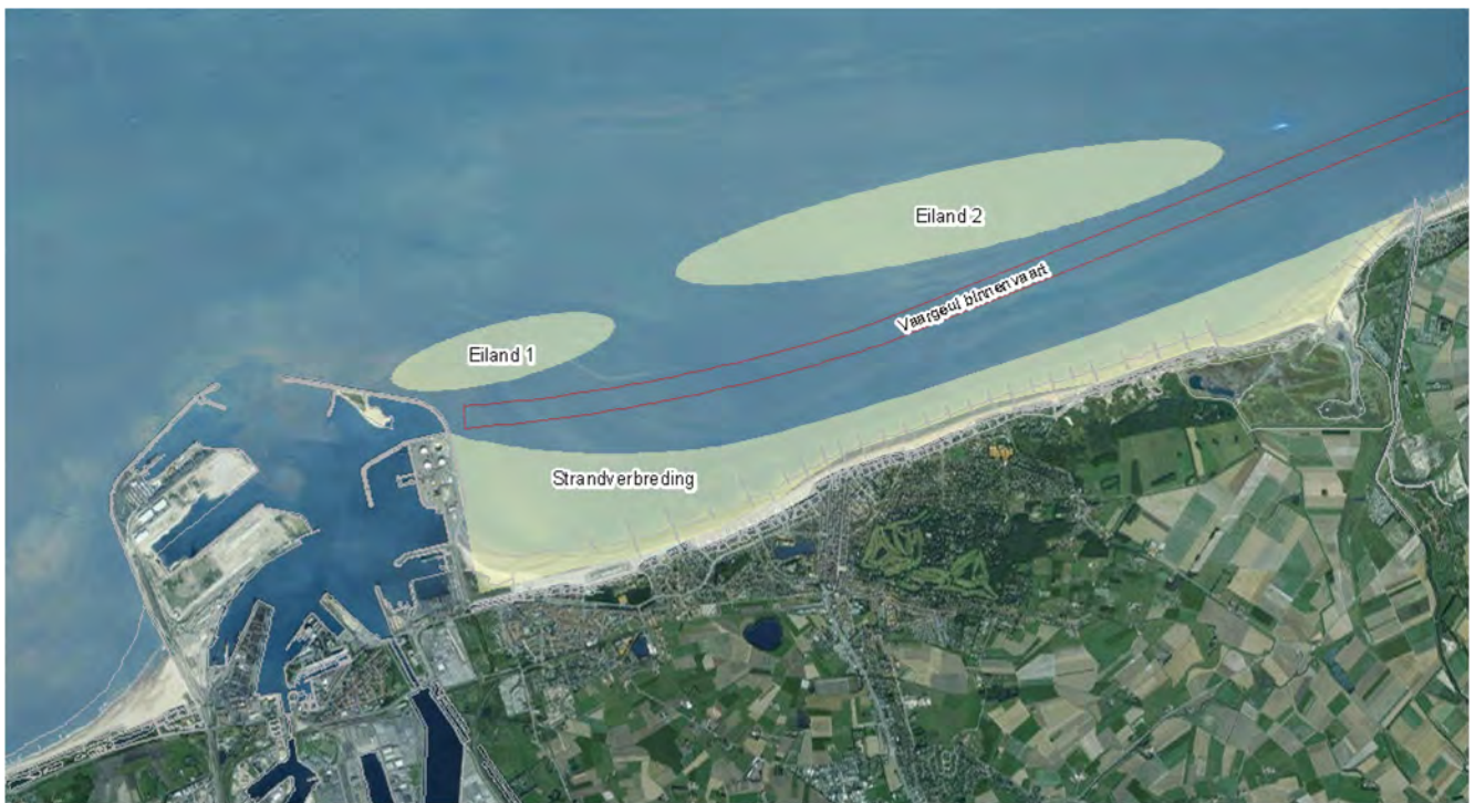
Figuur 28: Schematisch overzicht van de mogelijke ingrepen Vlaamse Baaien ter hoogte van de Oostkust.
