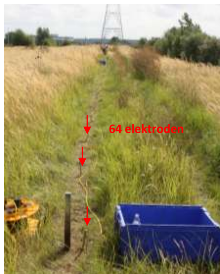
Figuur 2: Resistiviteitstomografie in het veld.
