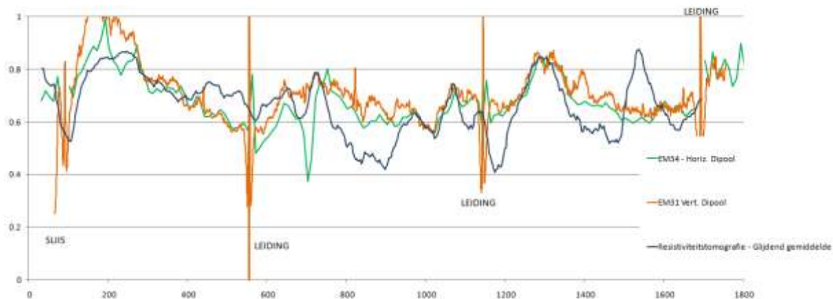
Figuur 12: Genormaliseerde vergelijking van EM34 (horizontale dipool, groen), EM31 (oranje) en de gemiddelde resistiviteit van de bovenste laag (6 m) van een resistiviteitstomogram te Berlare (blauw).
