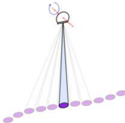
Figuur 20: Principe van de sector scanner.
