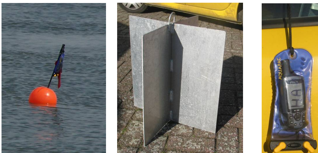
Figuur 3 – Onderdelen GPS vlotter: boei (links), kruisvormig paneel (midden), GPS-toestel (rechts)
