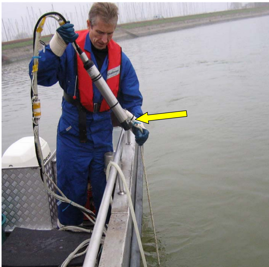
Figuur 2-4 OBS5 wordt neergelaten tijdens mobiele 13uurs-meetcampagne op meetschip "GeoXYZ"
