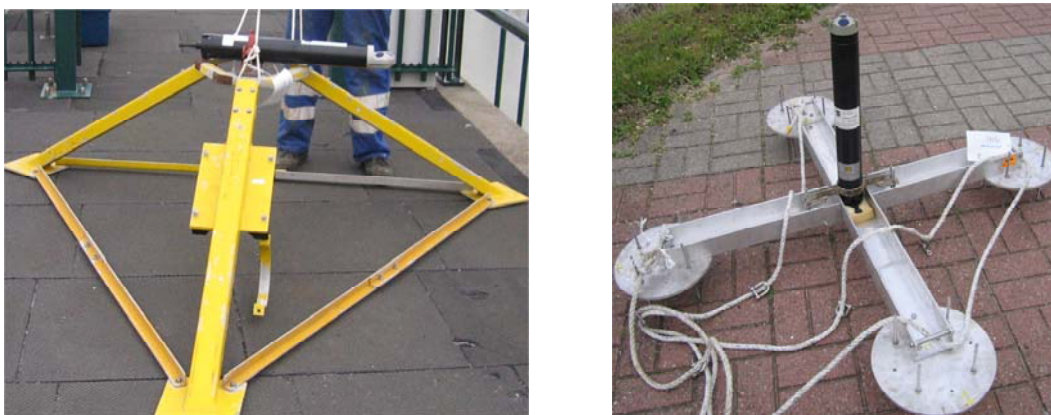
Figuur 2-6 Meetopstelling Aquadopp Profilers 2.0.MHz (links: opstelling locatie B & Bbis / rechts: locatie A)
