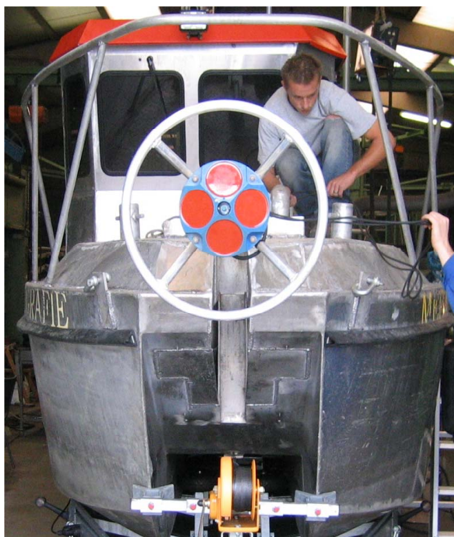
Figuur 2-3: ADCP gemonteerd op kantelbare aluminium paal op de neus van het meetschip "GeoXYZ"
