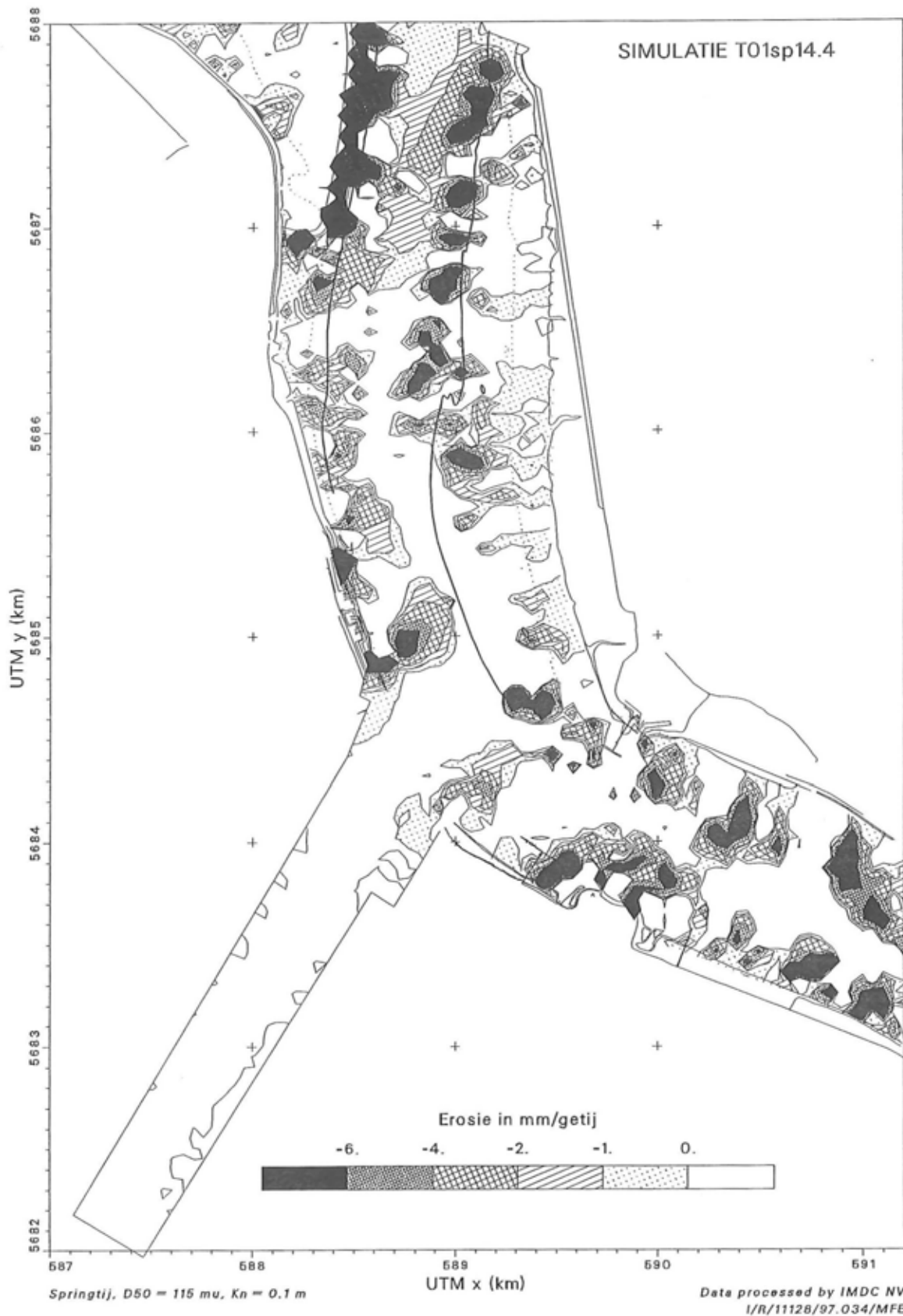
Figuur 7.15: Zandtransportsimulatie voor de Toestand T01-14.4 ter hoogte van de Drempel van Frederik: Erosie van zand in mm/getij
