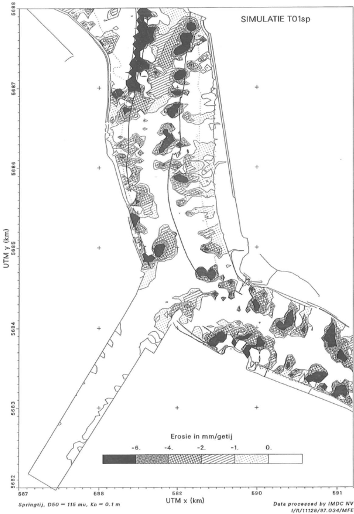
Figuur 7.7: Zandtransportsimulatie voor de Toestand T01-sp ter hoogte van de Drempel van Frederik: Erosie van zand in mm/getij
