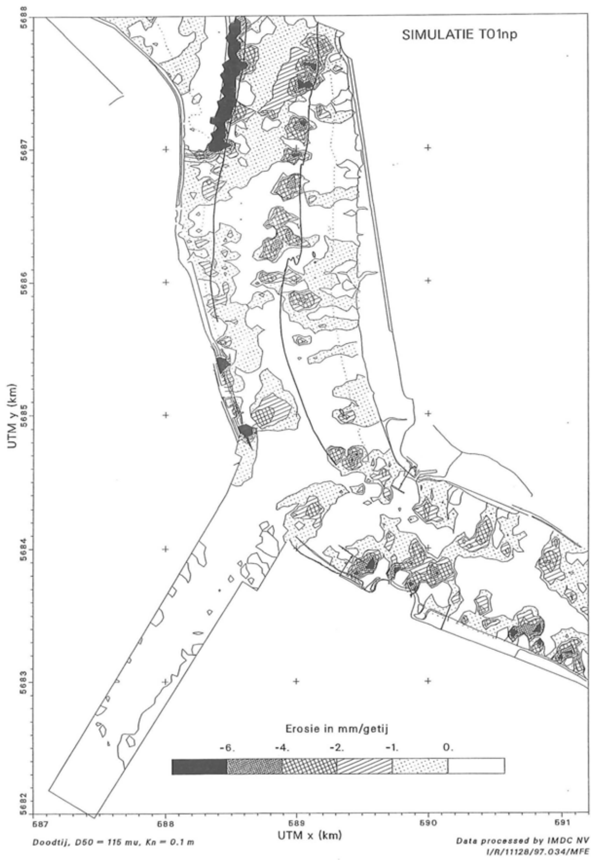
Figuur 7.11: Zandtransportsimulatie voor de Toestand T01-np ter hoogte van de Drempel van Frederik: Erosie van zand in mm/getij.
