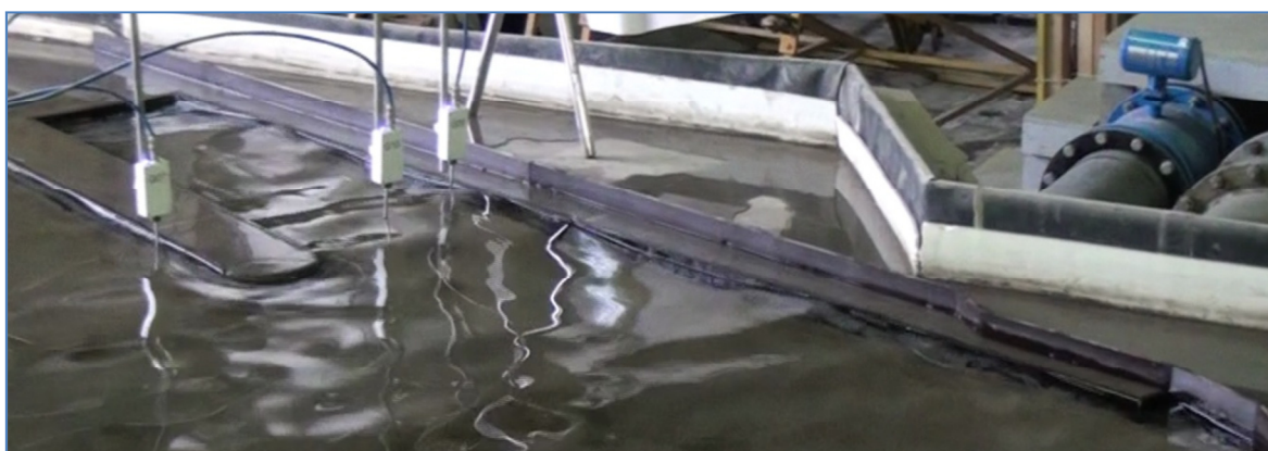
Figuur 3-16: Tijdok en Wandelaarkaai in het fysisch model. Waterstand +7.20m TAW: waterpeil zou zich boven de kaaimuren moeten bevinden en elke golf zou moeten kunnen overslaan, dit is echter niet het geval.
