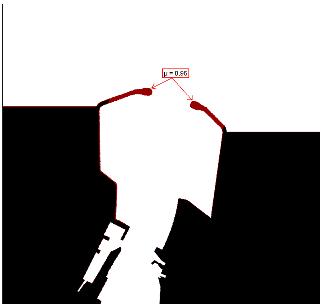
Figuur 3-45: Havendammen vervangen door sponslagen (donkerrood in figuur) met MILDwave absorptiecoëfficiënt = 0.95
