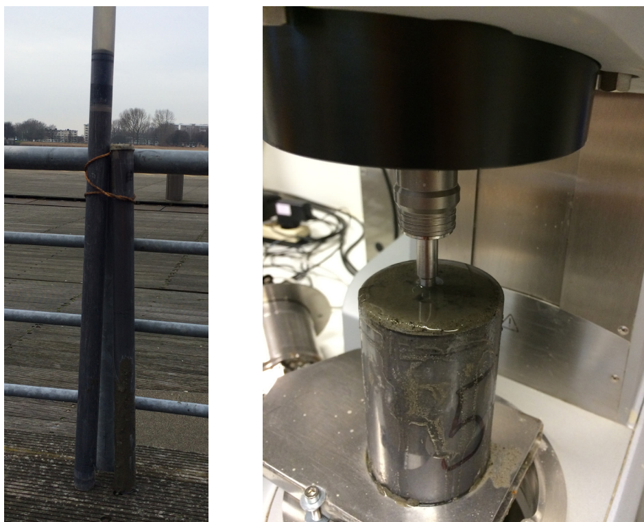
Figuur 5 – Bemonsteringsbuizen Beeker-sampler na monsternamen (links) en detail reometer (rechts)
