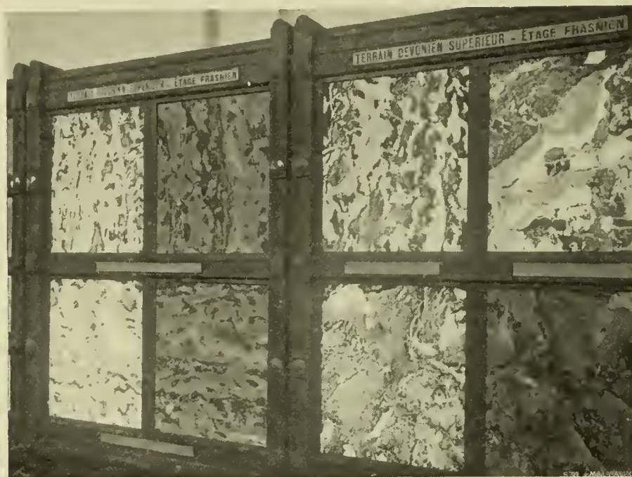
102. — Plaques minces, les unes transparentes, les autres opaques. Calcaire dévonien d'âge frasnien, à Stromatolites et à Acervularia . — Cliché Severin.
