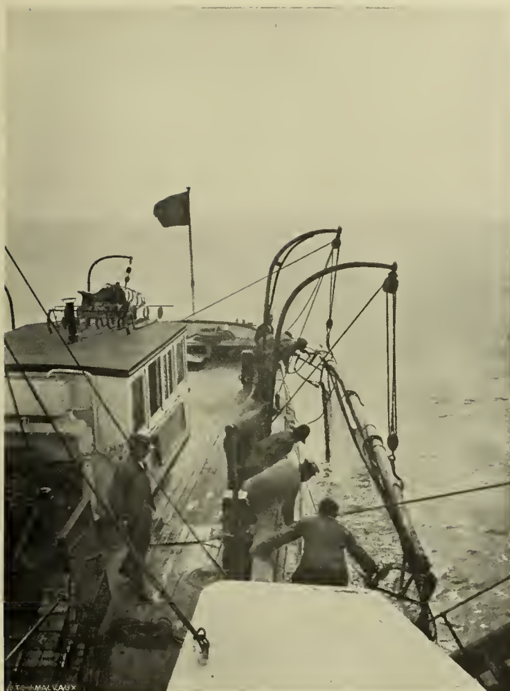
42. — Exploration de la mer. Instrument spécial: chalut à gaule, à fers déclinants.
