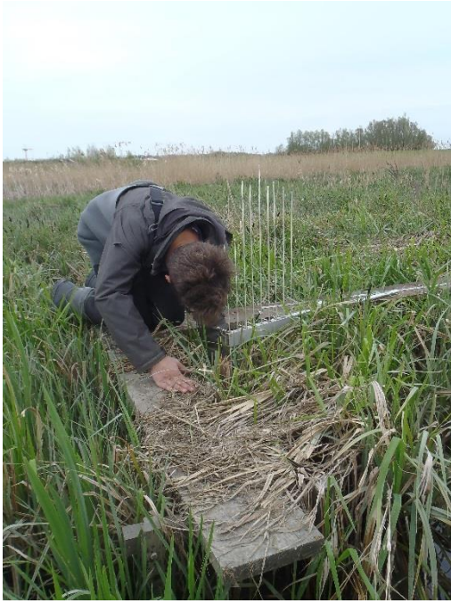
Figuur 2-2: SET-metingen in het Bazels GGG. Via de banken wordt vermeden dat de op te meten plots betreden worden. Indien er vegetatie aanwezig is op de locatie, wordt er steeds met de hand gecontroleerd of de stokken wel degelijk op het grondoppervlak rusten.
