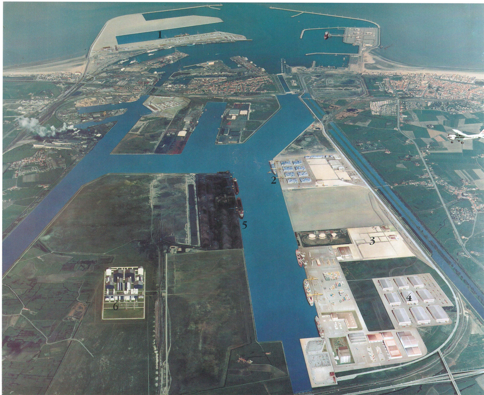
Afb. 4. De werken die werden uitgevoerd in het kader van het Raamkontraat, werden in 1990 voltooid en opgeleverd. De bouw van kaaimuren in de voor- en achterhaven moet nog verder gebeuren zodat nieuwe terminals en andere projecten kunnen ingeplant worden. Dit behelst o.m. : 1. De bouw van de containerkaaimuur in de westelijke voorhaven; de officiële start ervoor werd gegeven op 19 november 1991 door de heer Joban Sauwens, Gemeenschapsminister voor Openbare Werken en Verkeer. 2. De bouw van de kaaimuur (de Canadakaai) in de zuidelijke achterhaven werd beëindigd zodat de containerterminal voor Cast opgericht en afgewerkt kon worden. 3. De bouw van het ontvangst- en meetstation voor Noors aardgas en de aanleg van de Zeepipe. 4. De oprichting van het Distributiepark Zeebrugge. 5. De verlenging met 300 m van de Bastenakenkaai; de werken werden begin 1992 opgestart. 6. Een terrein van 20 ha werd gereserveerd voor de bouw van een elektrische centrale.
