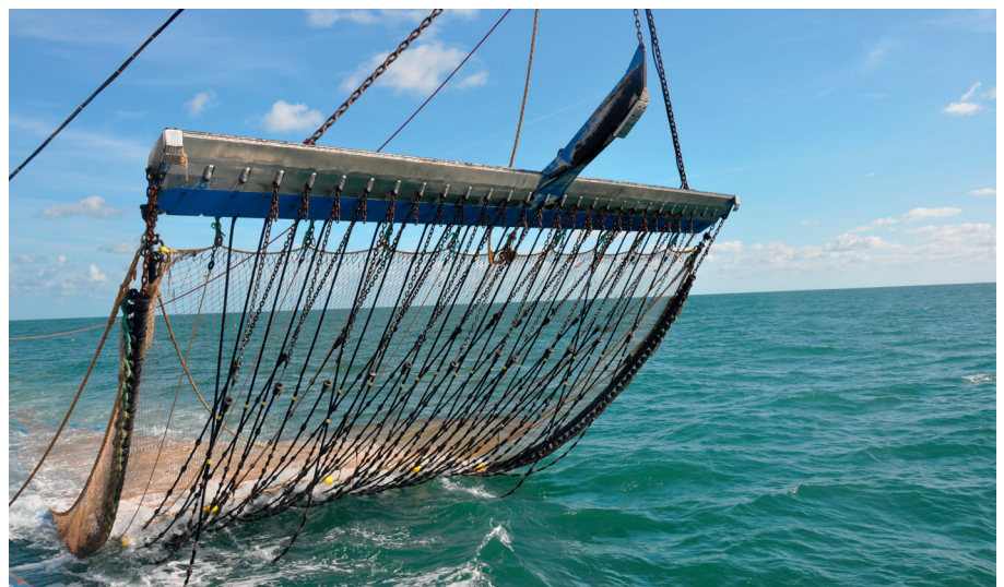
Een type pulskor specifiek ontwikkeld om tong met stroompulsen van de zeebodem op te schrikken (ILVO)
