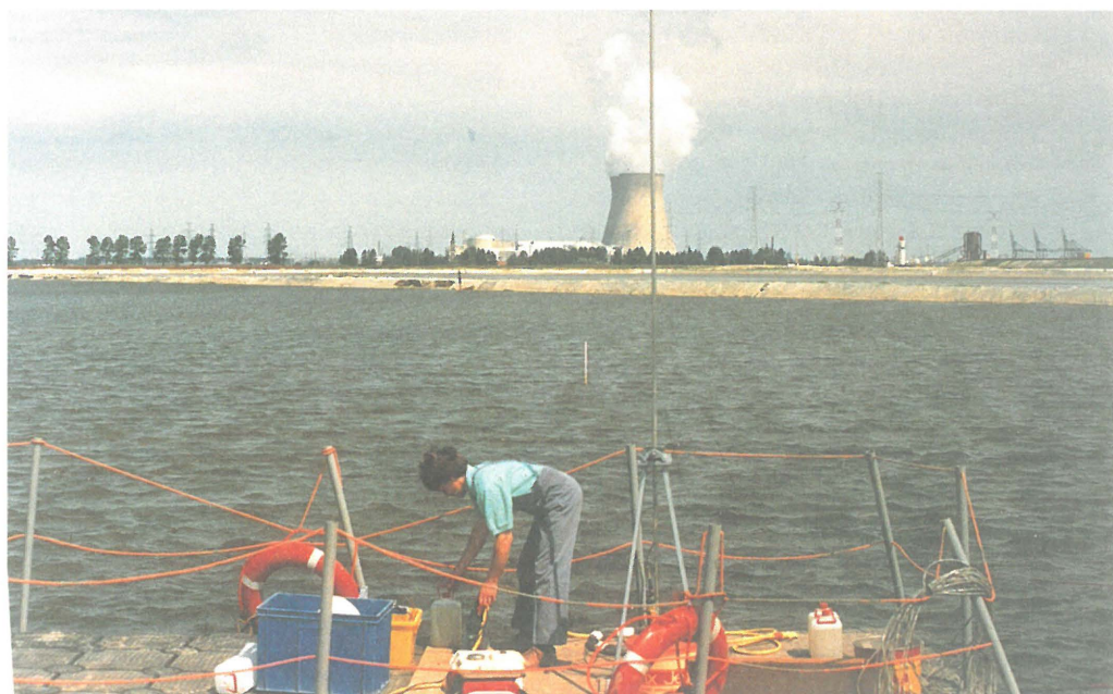
Peilen naar slib en meten van consolidatieprofielen in een slibstort op de Antwerpse Linkeroever (JB)
