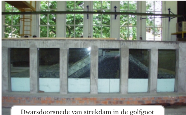
Dwarsdoorsnede van strekdam in de golfgoot
