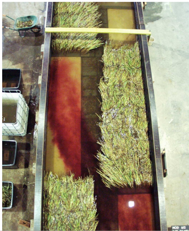
Inbouw van een fysisch model in een stroomgoot: onderzoek naar ecologisch maaibeheer.
