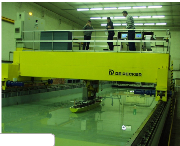
Sleeptank voor ondiep water.
