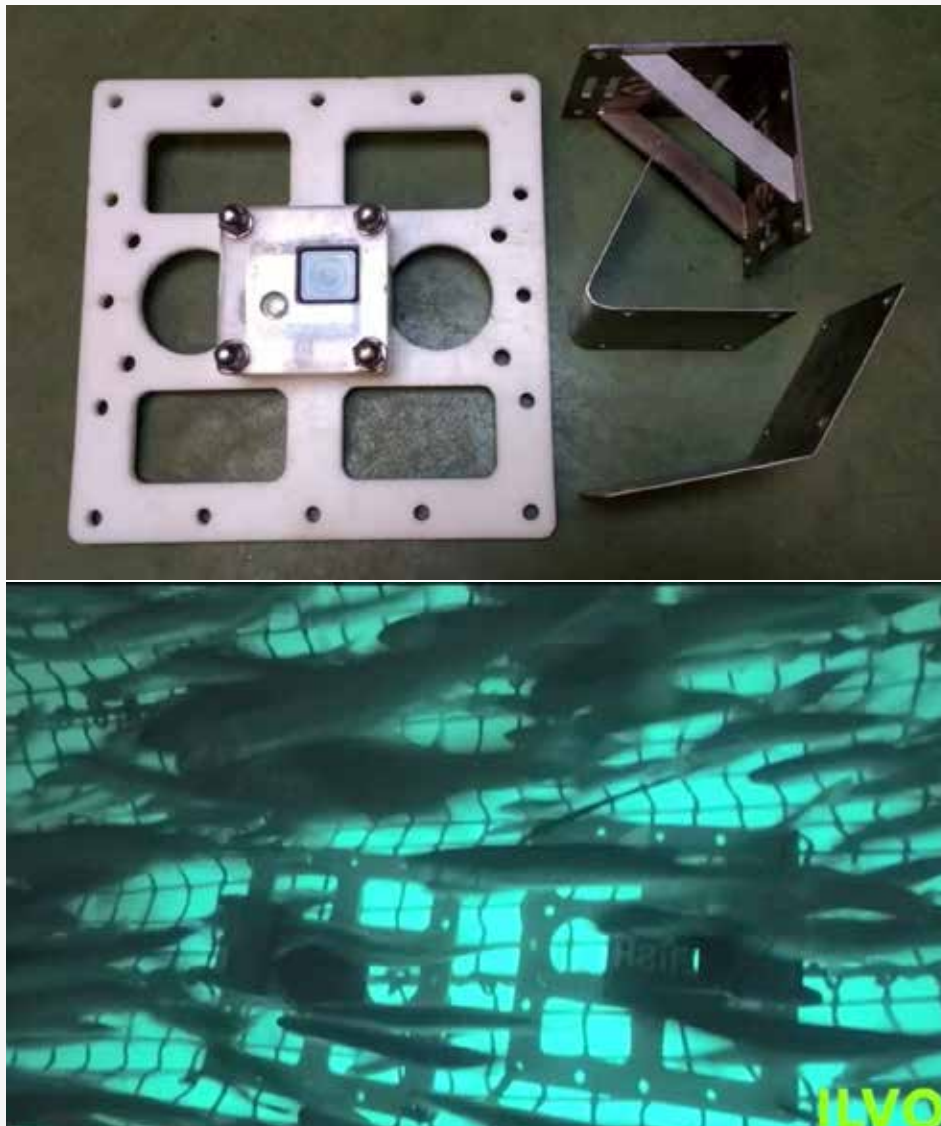
Fotoreeks 2: Een GoPro in extra omhuizing rechtstreeks in bevestigingsplaat met enkele metalen profielen waarmee de omhuizing onder een hoek t.o.v. de bevestigingsplaat kan gezet worden (boven) en GoPro beeld vanuit buik van ontsappingspaneel in rug van flyshootnet waaraan gopro's in bevestigingsbeugel hangen die onder een hoek van 90° naar voor en achter kijken (onder).
