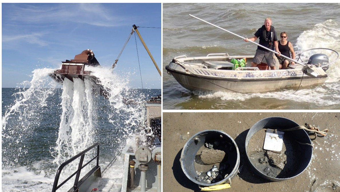
Figuur 3. De meest gebruikte monstertuigen: stempelkor (links), kokkelschepje (rechtsboven) en steekbuis met zeef (rechtsonder).
