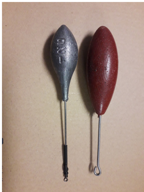
Figuur 4: Vergelijking van een overeenkomend longdistance-visgewicht in lood (links; 129 g) en composiet (rechts; 130 g).
