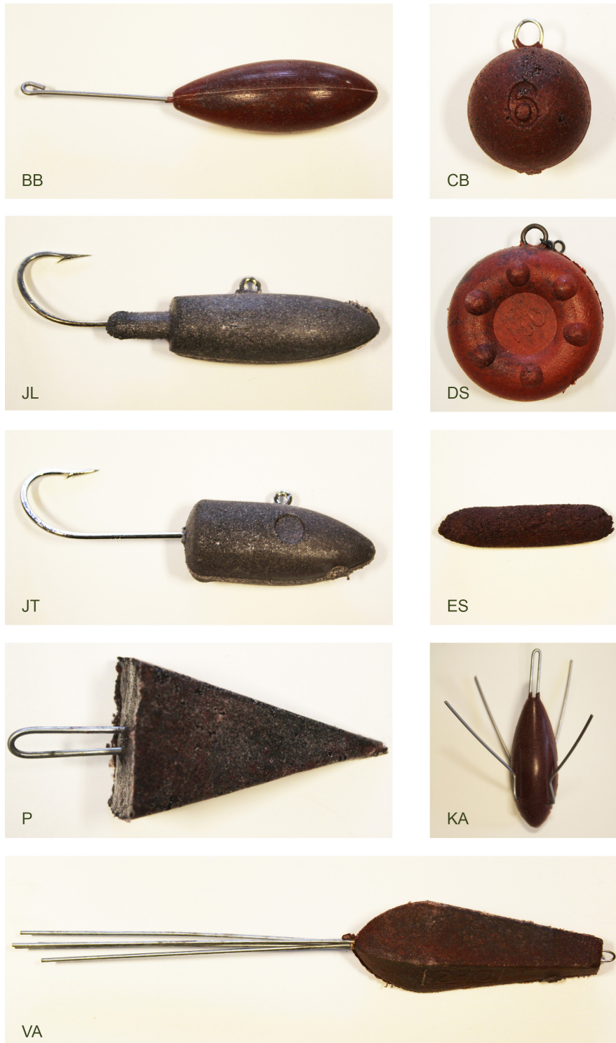
Figuur 3: Overzicht van de composietgewichten. Longdistancelood (beach bomb; BB); bollood (cannonball; CB); Jigkop lang (JL); Disk sinker (DS); Jigkop torpedo (JT); Egg sinker (in-line) (ES); Piramidelood (P); Klapankerlood (KA); Vast ankerlood (VA). (Bron foto's: VLIZ).
