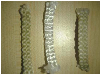
Figuur 5. Monsters van 1 jaar Gebruikt net – NG1 (links), nieuw ongebruikt net - NN (midden) en 4 jaar Gebruikt net - NG4 (rechts) na chemische reiniging.
