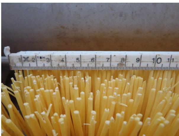
Figuur 7. Linker foto: Close-up van de borstels van de BRU6 aan de rand van de borstelrol.
