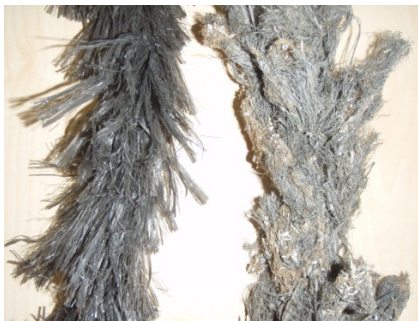
Figuur 3. Nieuw ongebruikt - TN (links) en gebruikt - TG (rechts) mosseltouw zoals aangeleverd .
