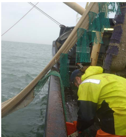
Figuur 2. Groene plastic- en paarse nylon slijtmatten aan de visnetten op een garnalenkoter (Bron IMARES Yerseke).
