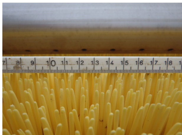
Figuur 7. Linker foto: Close-up van de borstels van de BRU6 aan de rand van de borstelrol.
