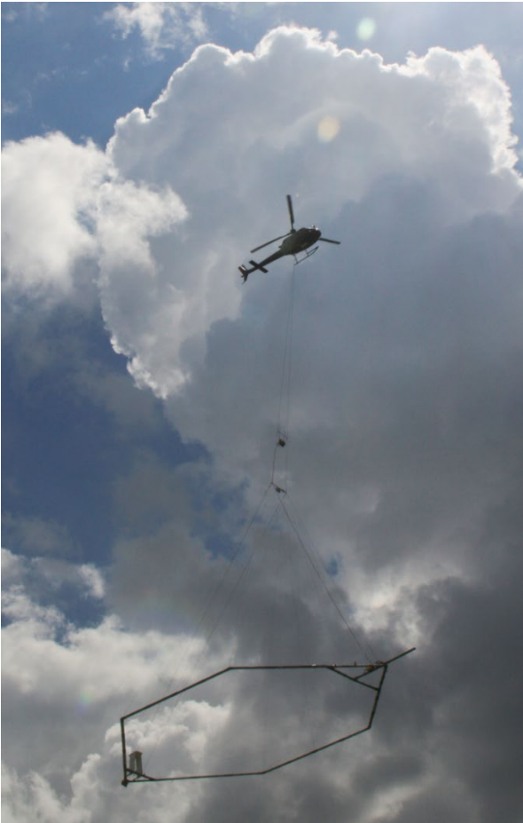
Figuur 5.1 Helikopter en meetframe boven Oostende-Brugge Airport.
