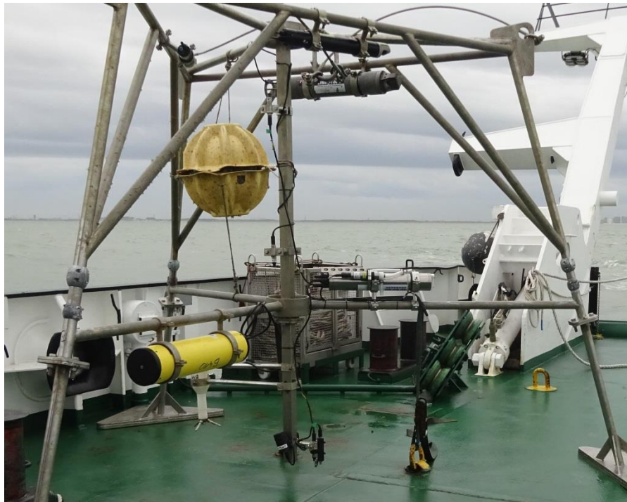
Foto 2. Tripode voorzien van SonTek ADV, Nortek ADP, 1 SonTek Hydra, SBE37, SBE19plusv2, 4 OBS-3+ sensoren en een LISST-100X.
