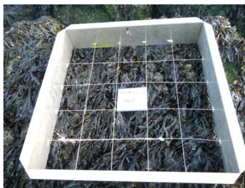
Figuur 3: Aluminium frame van 0,25 \text{ m}^2 dat is onderverdeeld in subkwadranten van 10 \times 10 \text{ cm} .
