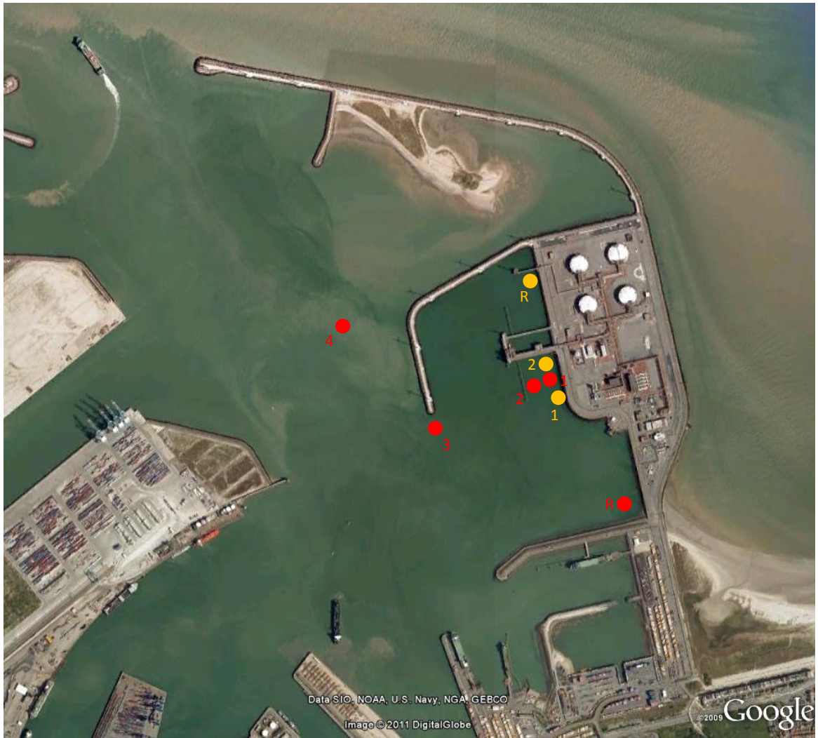
Figuur 2: Staalnamestations bemonsterd op 7 juni 2012. De rode punten (1, 2, 3 en 4 = impact en R = referentie ) duiden de macrobenthos- en sedimentstations aan; de gele punten (1 en 2 = impact en R = referentie) duiden de epifaunastations aan.
