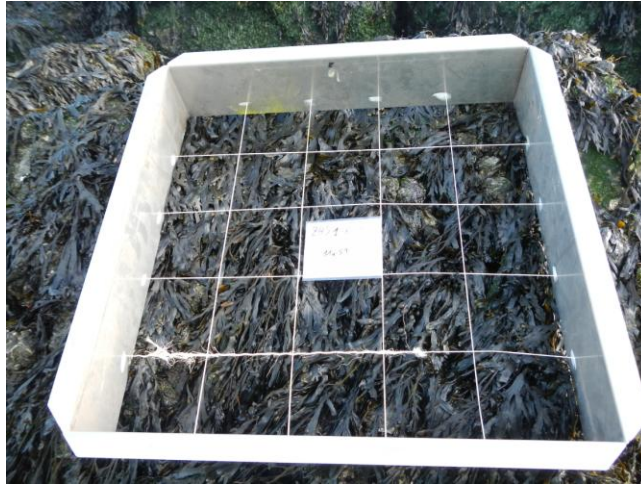
Foto 1: Aluminium frame van 0,25\text{ m}^2 dat is onderverdeeld in subkwadranten van 10 \times 10\text{ cm} .
