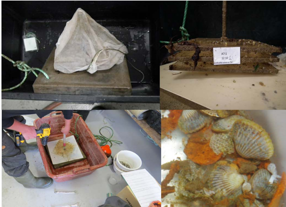
Figur 8. Substratet placerades i plastbalja (högst upp till vänster). Nätpåsen avlägsnades och en allmän beskrivning av substratet noterades (högst upp till höger). Substraten skruvades isär (längst ned till vänster). Faunan samlades upp i ren plastbalja (längst ned till höger).
