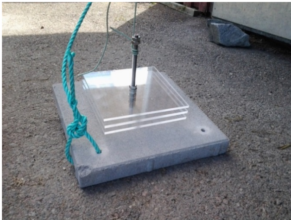
Figur 6. Provtagningssubstrat för hårbottenfauna. Från bojen löper en lina till provtagningssubstratet. För att underlätta läggningen av substratet fästs en lina till metallstaven som säkerställer att betongplattan lägger sig platt på botten. Vid upptagningen kan lägningslinan (gul) enkelt knytas upp av en snorklare och en nätpåse kan dras över plexiglasplattorna och isolera provet.
