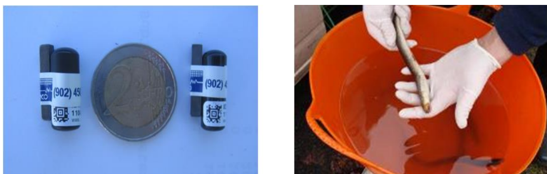
Figuur 9: Voorbeeld van de V8 en V7 zenders (links) die bij rivierprikken (rechts) werden ingeplant.
