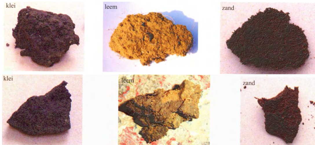
Figuur 7: Visuele voorstelling van structuurelementen voor een klei-, leem- en zandtextuur - bovenaan: 'goede' structuur: afgerond blokkige elementen - onderaan: 'slechte' structuur: scherpblokkige elementen
