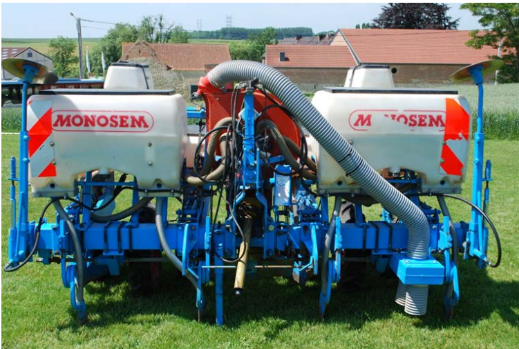
Afbeelding 28: Pneumatische zaaimachine met luchtuitlaat naar de grond gericht
