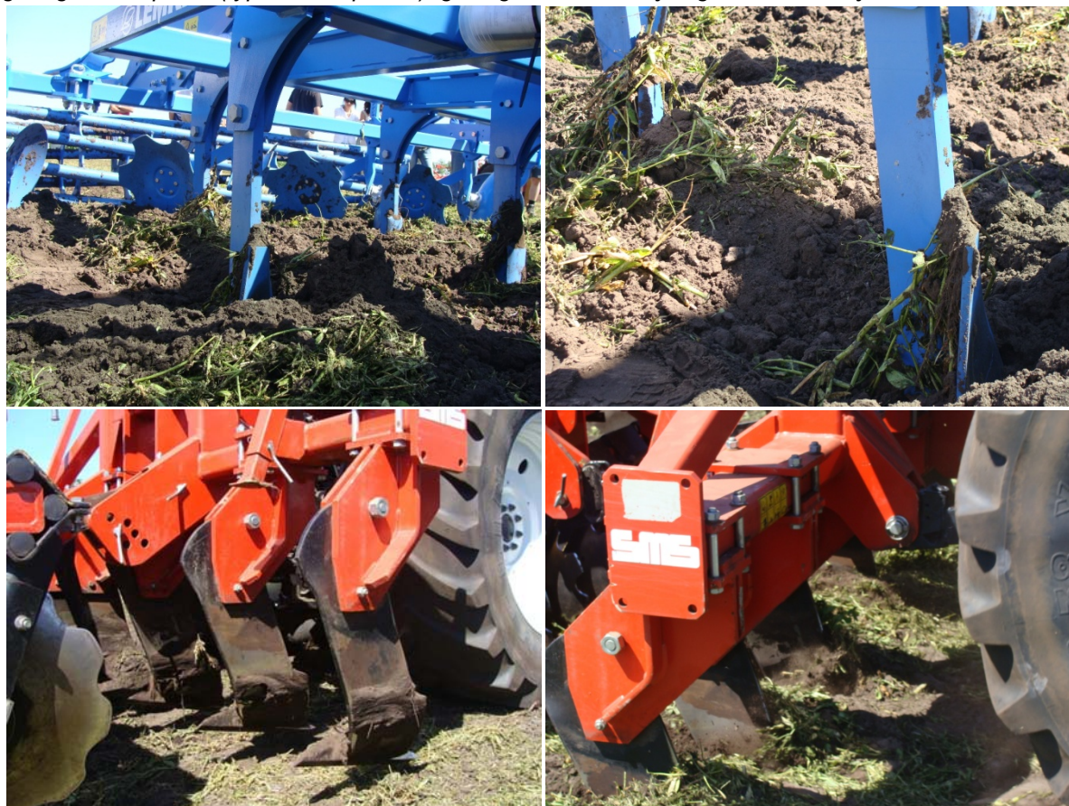
Figuur 22. Enkele voorbeelden van werktuigen voor niet-kerende grondbewerking. Boven: tandcultivator met smalle beitels, en achteraan twee rijen gekartelde schijven. Onder: woelerbalk met gebogen woelpoten (type decompactor), gevolgd door twee rijen gekartelde schijven.
