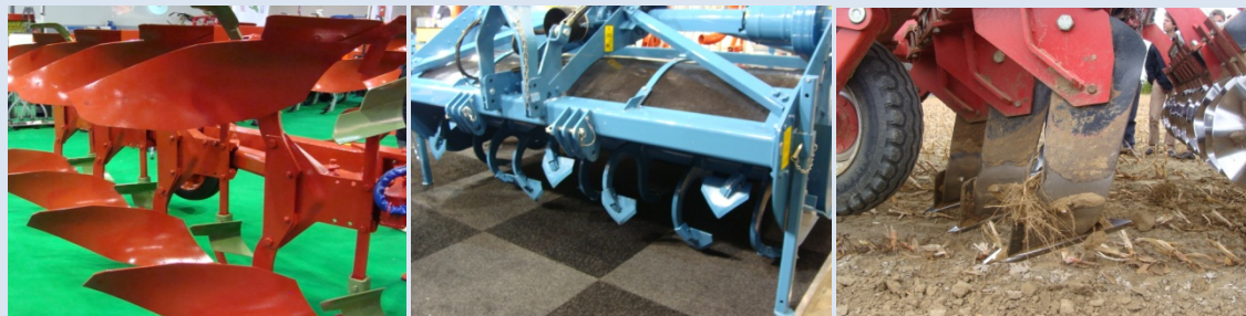
Figuur 17. Machines voor bodembewerking. Vlnr: ploeg, roterende spitmachine, decompactor.
