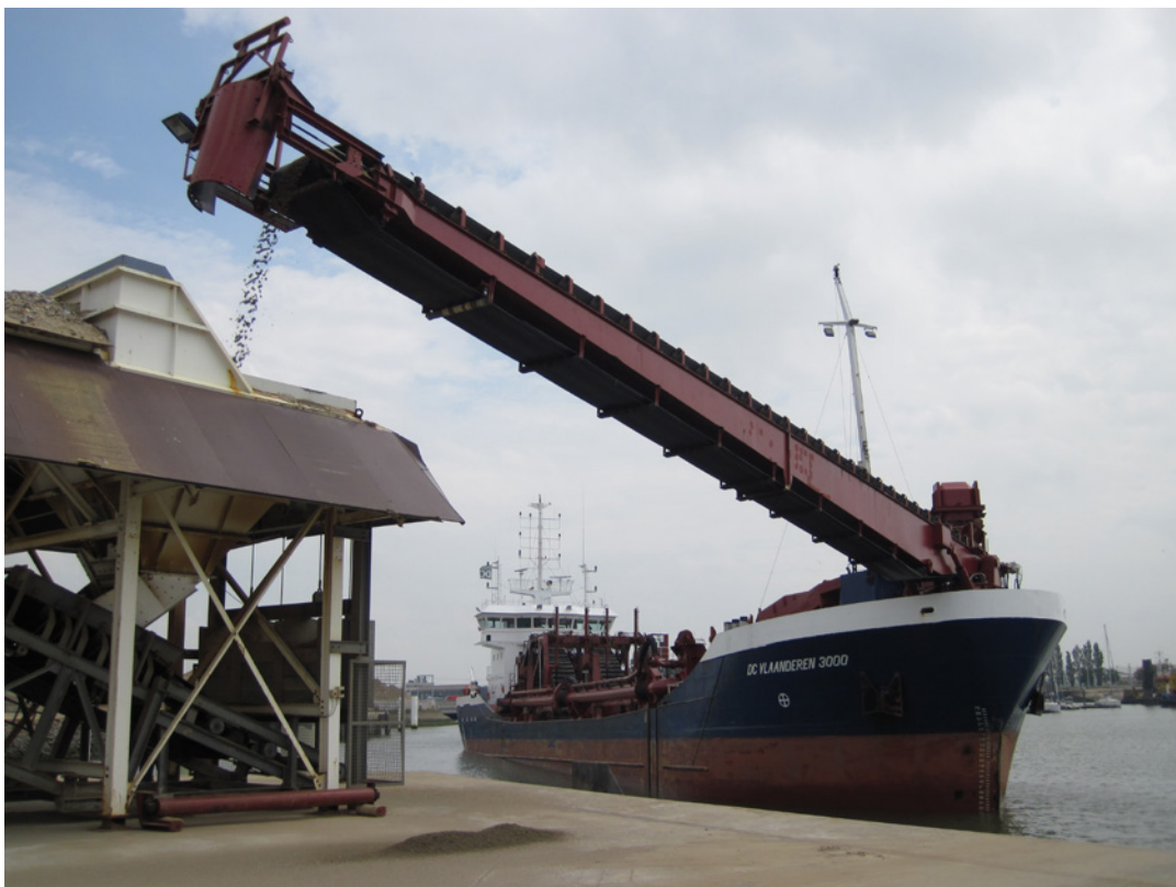
Figuur 9 – Een sleephopperzuiger bezig met het lossen van zeezand
