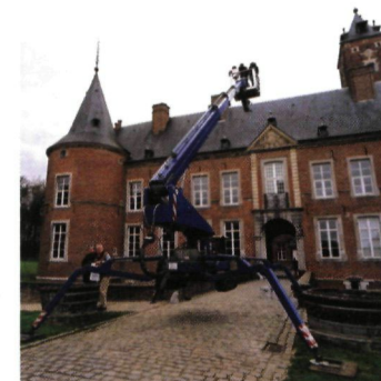
•• Opname met een metrische camera van op een hoogtewerker
