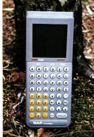
Handcomputer voor het opslaan van terreingegevens bij de bosinventarisatie.
