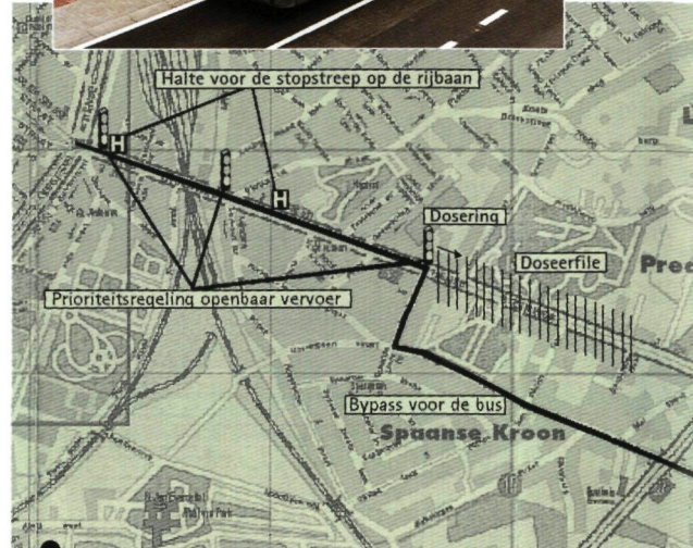
Schematische weergave van de voorgestelde maatregelen: 1. verkeersdosering - 2. inplanting bushaltes - 3. prioriteit bus aan de verkeerslichten.
