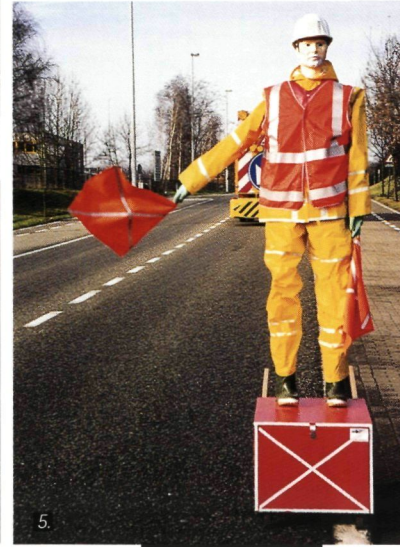
1. Meting van spoorvorming met behulp van de Rutmeter. 2. Stroefheidsmetingen. 3. Vlakheidsmetingen 4. De botsabsorbeerder. 5. Betere veiligheid door het gebruik van de mechanische pop.
