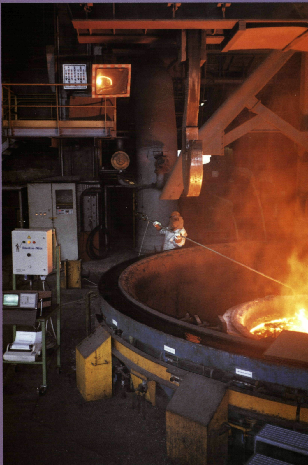
Sensor voor het meten van waterstof in vloeibaar staal (HERAEUS ELECTRO - NITE nv)
