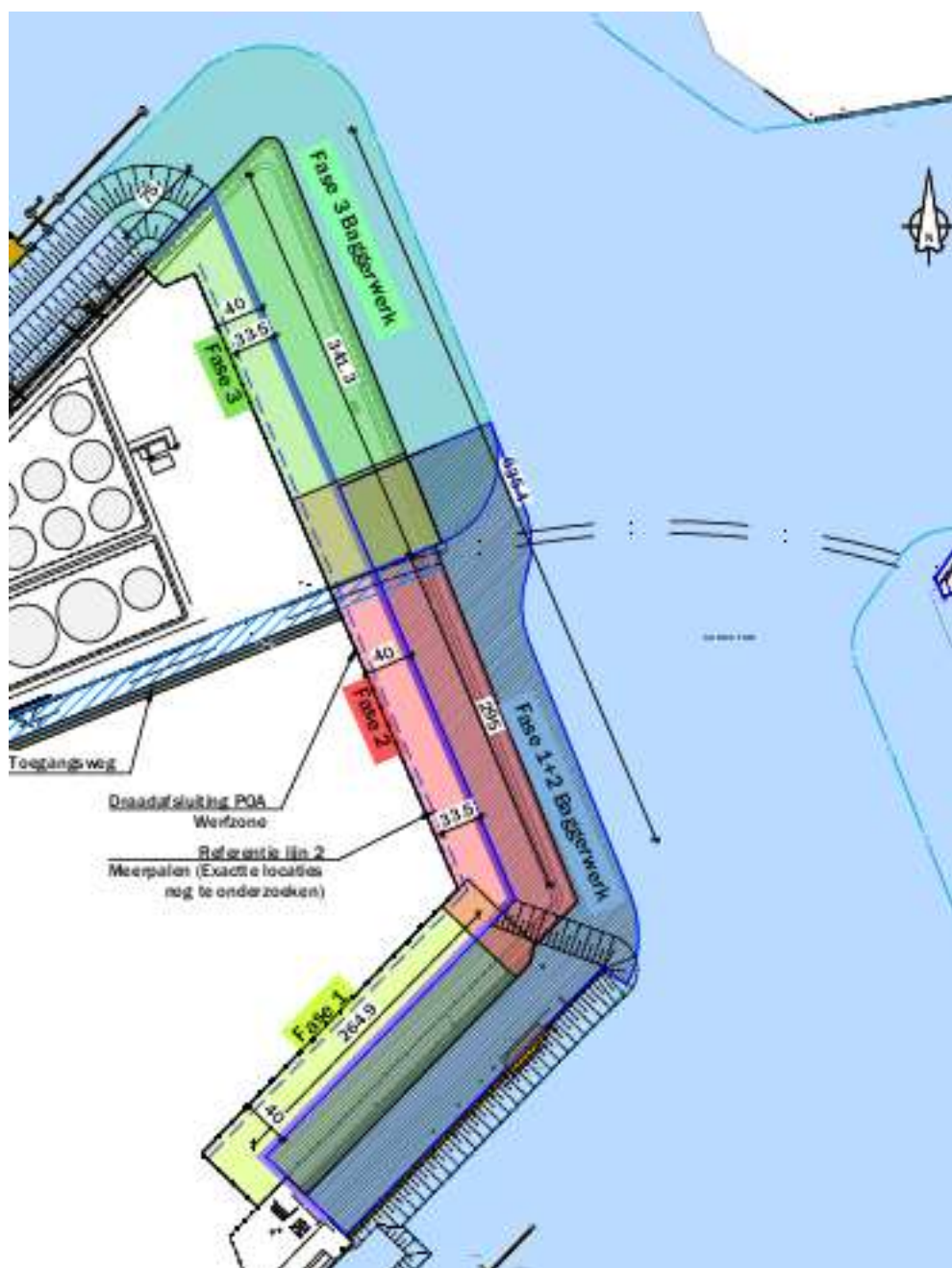
Figuur 2-6: Fasering kaaimuurwerken
