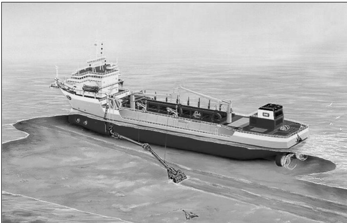
Figuur 2.5–1: Visualisatie van ontginning met een sleephopperzuiger (presentatie Geert De Poorter, Studiedag Zandwinning, 2014)
