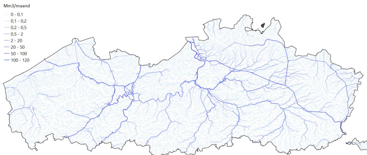
Figuur 188: Oppervlaktewaterbeschikbaarheid langs de beschouwde onbevaarbare en bevaarbare waterlopen en kanalen: waterloopdebietvolumes in Mm 3 /maand per waterloopsegment, voor juli 2018.
