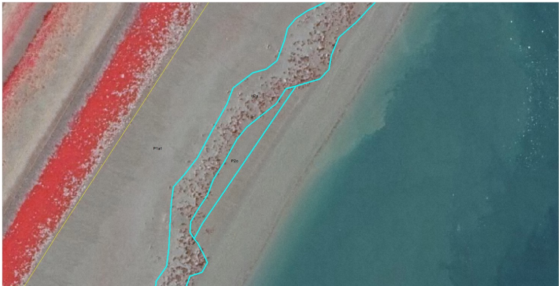
Figuur 9: Voorbeeld elimineeractie vlakje <math><100\text{m}^2</math> uit de e-GMK. Het vlakje P2c is door het afsnijden op de 4% DVD-lijn kleiner geworden dan volgens de specs is toegestaan. Dit vlakje is bij het hardsubstraat vlak toegevoegd.
