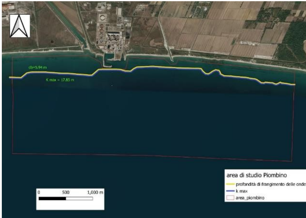
Figura 24 - Ubicazione della profondità di frangimento delle onde e K_{max} (vedi figura 20) nell'area di Piombino. In rosso è indicato il limite dell'area indagata e in verde sono visualizzati la profondità di frangimento ( db = 5,94 \text{ m} ) e la distanza di k_{max} da db ( 17,85 \text{ m} ).
